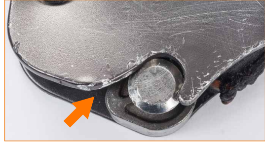
Taipunut sivulevy ei enää istu tiiviisti sulkutappia vasten.
