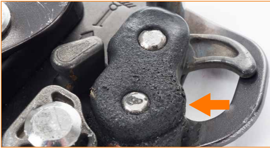
Kuumenemisen vuoksi vakavasti vaurioitunut valintakytkimen rakenne.
