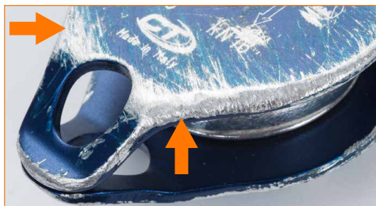
Runko, jonka ulkosivuilla on huomattavia kulumisen merkkejä.
