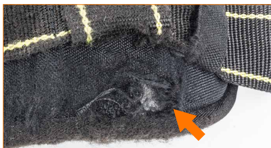
Erittäin kulunut pehmuste. Ei-rakenteellisten komponenttien kulumista ei pidä vähätellä, koska se on osoitus laitteen yleisestä kulumisesta.
