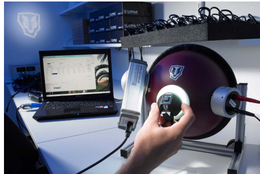
Messung der Lichtleistung
